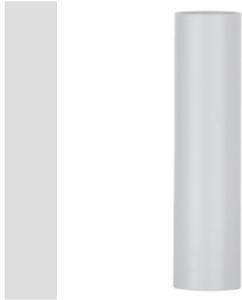
Sistema de tubo de protección rígido pesado serie RKB en PVC con clasificación 4321. En conformidad con las normas IEC 61386-1 e IEC 61368-21. La gama se compone de tubos en 7 diámetros desde 16 a 63 mm, en barras de 3 metros. Idoneos para instalaciones de energía y/o datos. Aplicaciones: canalizaciones superficiales vistas en paredes y techos.
