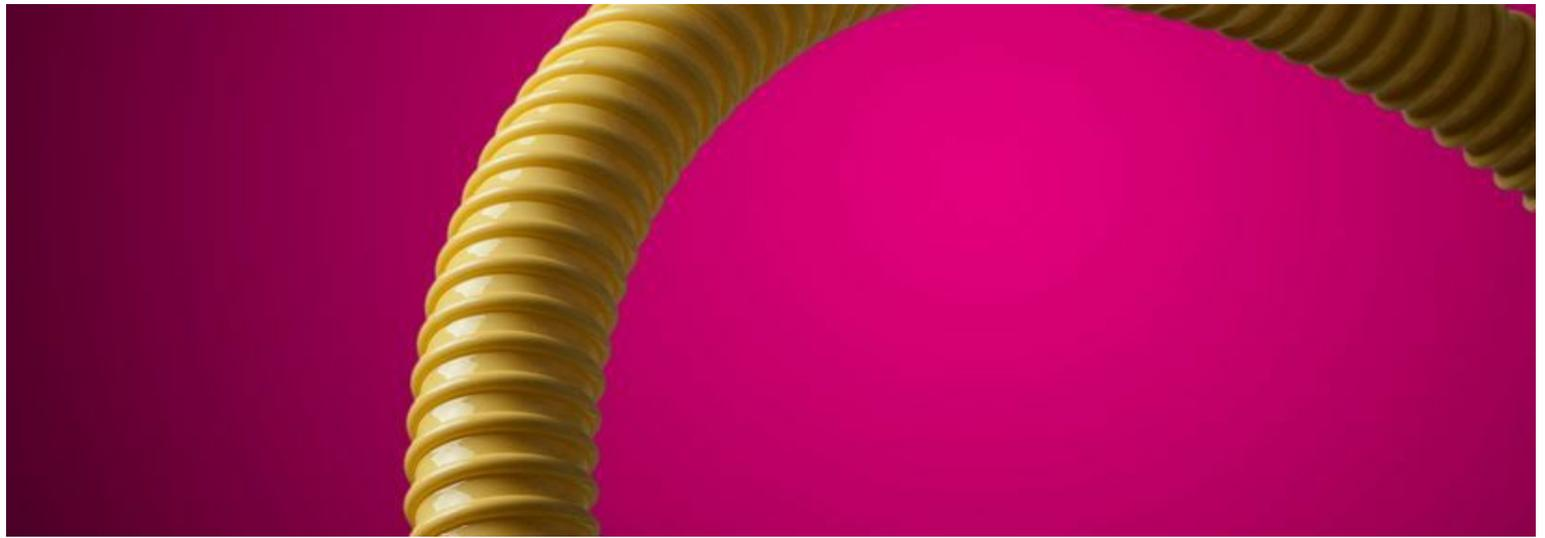
Tubería flexible fabricada por co-extrusión de PVC flexible, con refuerzo de espira de PVC rígido.
