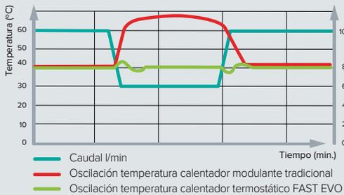
Accionando un único mando el usuario siempre consigue la temperatura deseada aunque varíe el caudal. Ello es posible gracias a la sonda NTC y a la modulación del quemador, que garantizan una temperatura constante.
